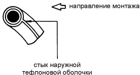
Рис. 5: Стык наружной оболочки обращен против направления монтажа
